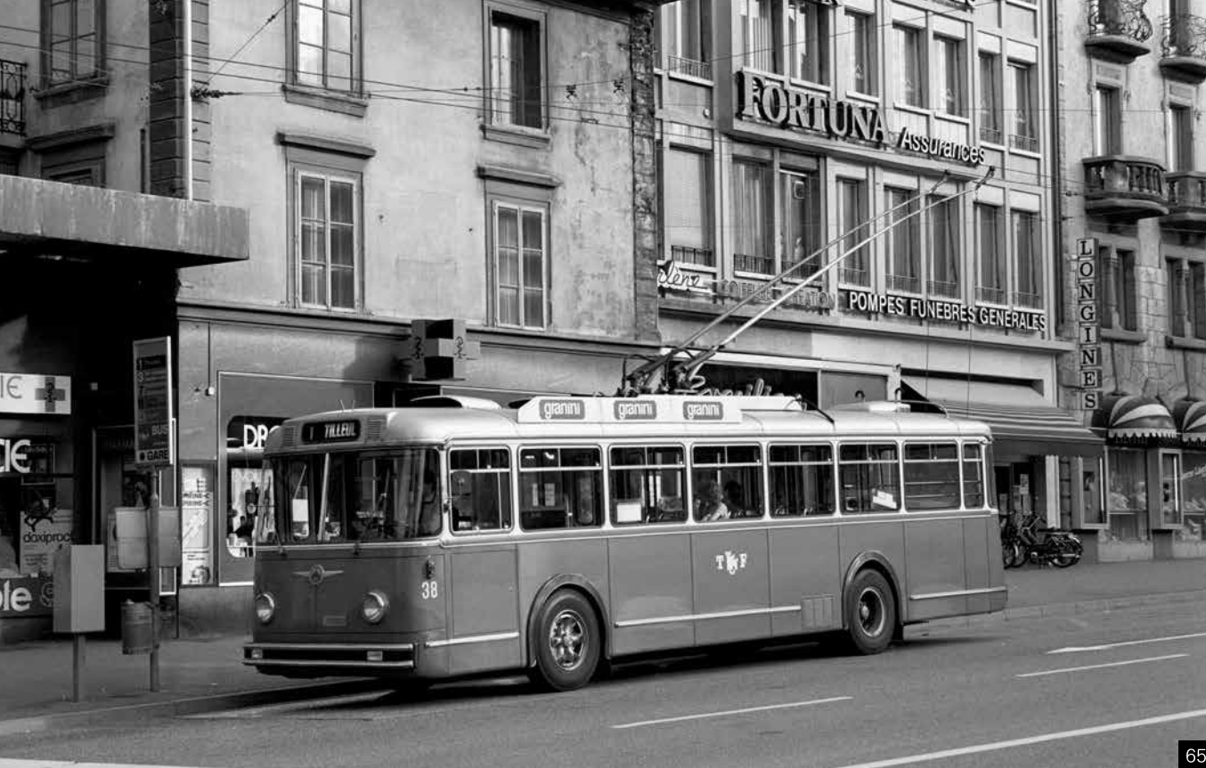
Abb. 65 (1986) Gare: Die Saurer/Hess/SAAS 4TP54 Trolleybusse bestachen durch eine zeitlos elegante Karosserielinie. Wagen 38 (1965) passiert von Pérolles her die Bahnhofs-Haltestelle in Richtung Tilleul (Stadtzentrum).
