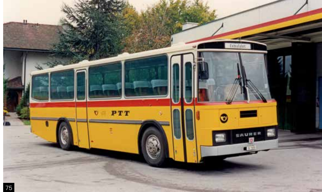
Abb. 75 (1996) Flums SG: Die RH Reihe unterteilte sich bei PTT-Regie und bei Postautohaltern in Reise- und Kursfahrzeuge. In der Reisewagenversion hatte PAH Heim, Flums, diesen Saurer/Tüscher RH525-23 SG5650 (1979) im Einsatz. 1998 wurde das Postauto verkauft.
