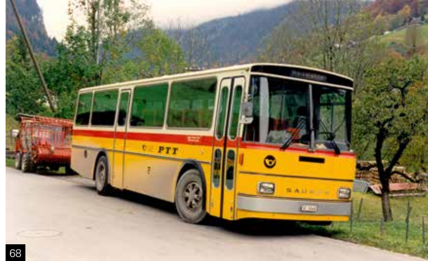
Abb. 66 (1980) Niederuzwil SG: Mitte der 70er Jahre befassten sich die Automobilabteilung PTT und Saurer mit dem Projekt eines Kurs- und Reisewagen-Chassis mit liegendem Heckmotor. Das Resultat war der Prototyp Saurer/ R+J KH525-23 P29951 (1976), der 1977 an PAH Schwizer, Goldach, abgegeben wurde und dort als SG39524 eingereiht war. Die Erfahrungen flossen in die RH Serie ein. 1990 wurde der Bus abgebrochen.
