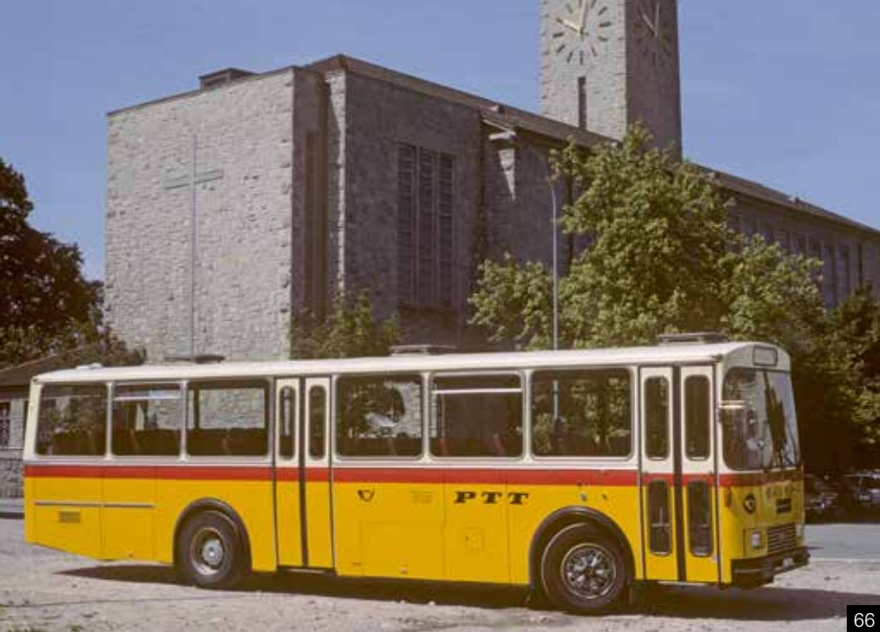
Abb. 67 (1978): Ein weiterer Prototyp, der Saurer/Lauber KH575-25 VS3108 wurde 1978 an PAH Perrodin, Le Châble, abgeliefert. Unsinnigerweise – das Fahrzeug besass grosse Unterflurgepäckräume und einen Heckgepäckraum – lautete die Saurer Bezeichnung auf SH (Stadtbus). Dieses Fahrzeug steht gewissermassen Pate für die RH Modelle der Grösse V, es besass zwar kein Zentralrohr-Chassis, aber bereits die Neoplan Vorderachse.
