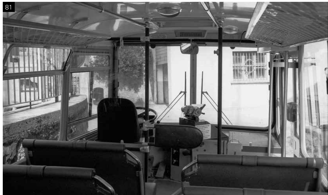
Abb. 81 (1972): Der Passagierraum des FBW/Rizzi 40UA43L P23505 (1971) kann je nach Sichtweise positiv oder negativ beurteilt werden: nüchtern, hell, grossflächige Fenster, einfache, aber zweckmässige Bestuhlung in Form von kunstlederüberzogenen, gepolsterten Bänken.
